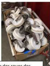
Remplacement du modèle des roues des chariots de stockage de ravers inox pour en faciliter la manutention
