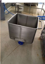
Modification des guides des lifts à pétrin pour faciliter l'introduction et la sortie des pétrins sans les détériorer et remplacement de 10 % du parc de pétrins 200L en 2019 (état général dégradé par les lifts)
