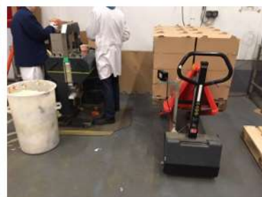
Achat de transpalettes électriques à haute levée pour faciliter la palettisation sur les poste à faible cadence
