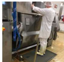
Mise en place de rehausseurs sous les cuiseurs pour faciliter le versement des bacs d'épices Le marche-pied glisse sous la machine après utilisation
