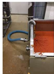
Généralisation des cannes d'aspiration pour le transfert des sauces des cuves vers les doseurs pour les lignes non raccordées en direct (idée et prototype développé par un opérateur sur son poste de travail !!). Plus de flexion du dos pour la mise en place des conduites
