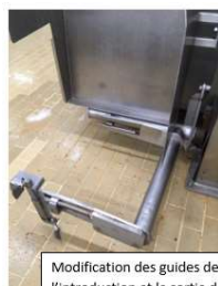
Mise en place de rehausseurs sous les cuiseurs pour faciliter le versement des bacs d'épices Le marche-pied glisse sous la machine après utilisation
